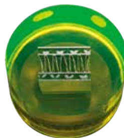
蛍光染料のエポダイを樹脂と混ぜることで、蛍光性の光下での試料検査時に孔部や亀裂を識別しやすくなります。
