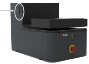
■ 在虚拟样品上运行几次硬度测试,以便牢固地固定载物台。
