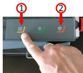
Pokrenite pumpu. 1 = pokretanje, 2 = zaustavljanje
