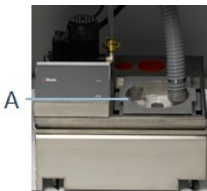
A Statická filtrační jednotka
