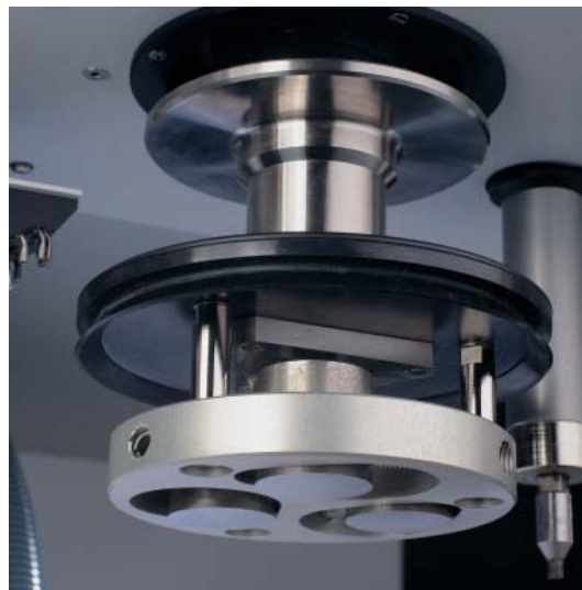
Prepamatic-2 prépare des échantillons individuels ainsi que des échantillons serrés dans des portes-échantillons.
