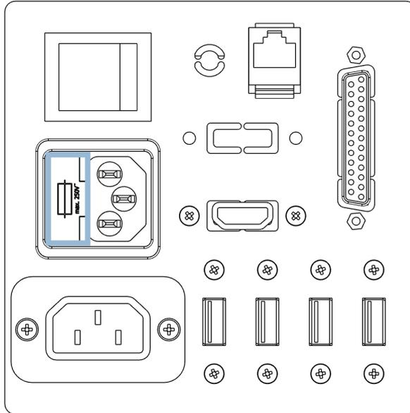
Le porte-fusible est situé directement au-dessus de la prise de courant à l'arrière de la machine.
