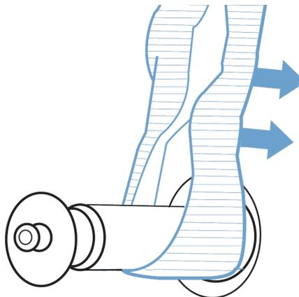
3. Placer les sangles de levage solidement autour de la barre de levage.
