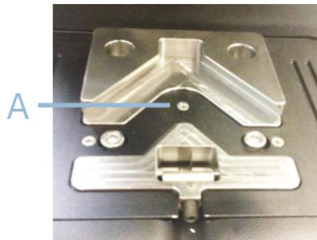
5. Serrer la vis de fixation pour maintenir la platine en place. **[A]**
