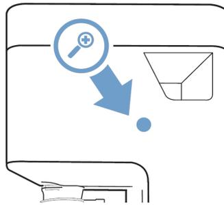
1. Retirer les couvercles à trou en plastique qui recouvrent les trous de la barre de levage.
