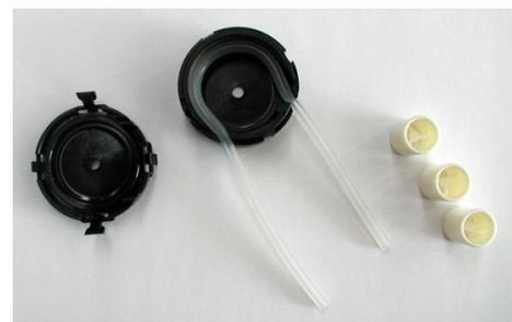
5. Ziehen Sie den Novopren-Schlauch ab.
