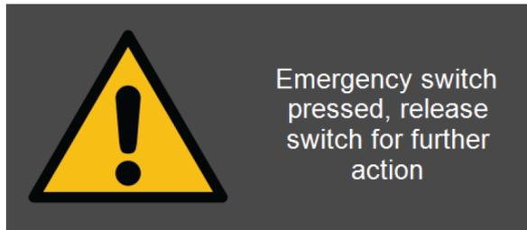
Die Maschine hält an und es wird eine Meldung angezeigt, die Sie auffordert, den Notstopp freizugeben. Sollte dies nicht der Fall sein, wenden Sie sich an Struers Service.
