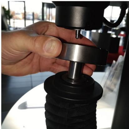
Um den Prüftisch (neu) zu platzieren, bewegen Sie die Spindel ausreichend weit nach unten und setzen/heben Sie den Prüftisch vorsichtig auf/von der Spindel ab.
