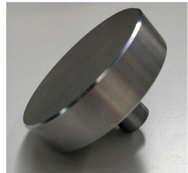
Flacher Prüftisch für ebene Proben. Verschiedene Größen stehen zur Verfügung:
