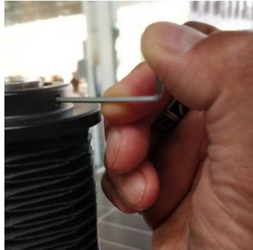
Lösen Sie die kleinen Sechskantschrauben, mit denen die Spindelabdeckung befestigt ist.
