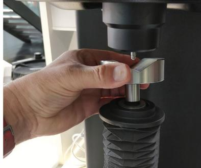
Um den Prüftisch (neu) zu platzieren, bewegen Sie die Spindel ausreichend weit nach unten und setzen/heben Sie den Prüftisch vorsichtig auf/von der Spindel ab.
