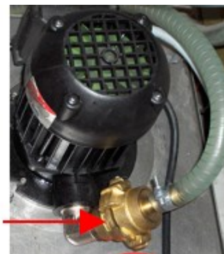
A Ausgang der Pumpe
