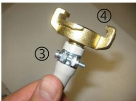
Posizionare il morsetto a vite ③ sul tubo.
