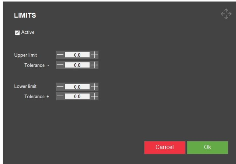
2. Impostare **Upper limit** (Limite superiore) e **Lower limit** (Limite inferiore).
