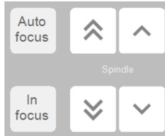
6. Utilice los botones de posicionamiento del **Spindle** (Husillo) para enfocar manualmente la superficie de la muestra.
